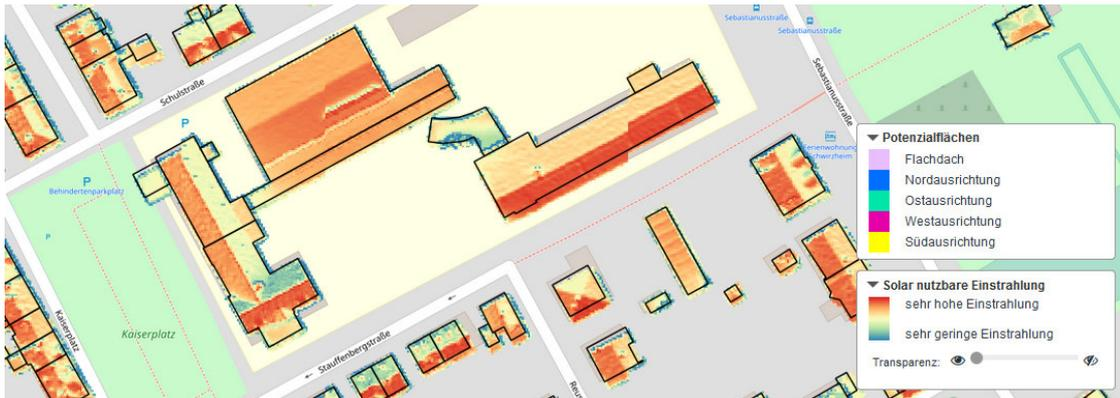
Bei einer Süd- bis Südwestausrichtung des Daches und geeigneter Bausubstanz ist eine Amortisierung der Entstehungskosten in ca. 10 bis 15 Jahren zu erwarten
